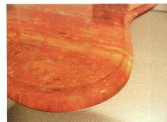
Die CNC-bearbeitete „Glasplatte“ mit imitiertem Marmor-Unterdruck war eine Auftragsarbeit vom Stadtmuseum Freiberg und wurde nach einer Vorlage rekonstruiert
